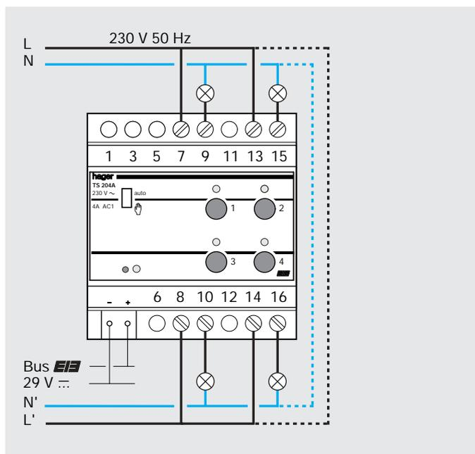
Nota : les différentes sorties peuvent être raccordées sur des phases différentes.
